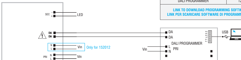
Programming via DALI - Programmazione tramite DALI
