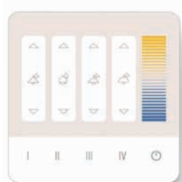
TW slider, dim slider, 4 grupper, 4 scener, av/på.
